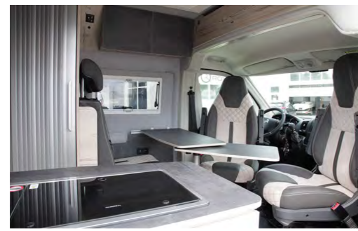
Das Augenmerk von Robeta liegt auf der Verwendung von hochwertigen Materialien. Die 25 mm starke Armaflex Isolierung sorgt im Sommer sowie im Winter für ein komfortables Raumklima. Die Möbelplatten sind mit einer 0,6 mm starken kratzfesten HPL Schicht versehen. Die Decke sowie Heck- und Seitentür sind mit Kunstleder verkleidet.
